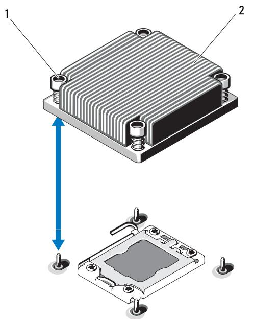
1 散热器固定螺钉 (4 颗)      2 散热器
