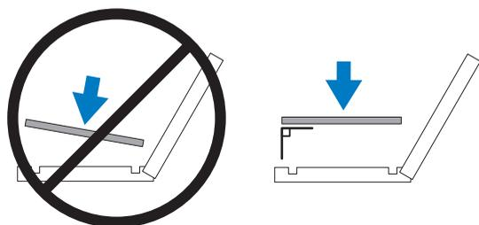
图 3-23. 将处理器与插槽卡锁对准
